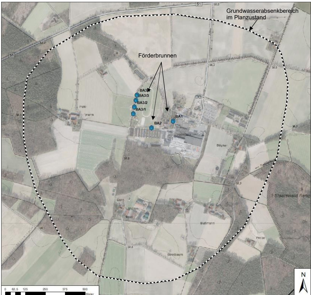
Abb. 1: Lage der Brunnen, Absenkbereich und Untersuchungsraumgrenze
