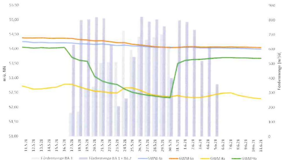
Abbildung 13: Wasserstände im nahen Umfeld der BA 3
